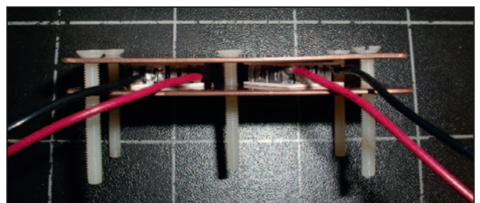
Abb. 3: Zwei PE zwischen zwei Kupferplatten. Eines wird am Netzgerät angeschlossen, das andere am Spannungsmessgerät.
